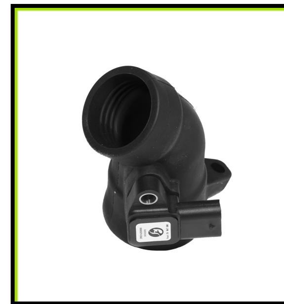
Otro elemento innovador desarrollado en Vertigo es el **sensor de presión y temperatura** colocado en la tobera de admisión. Permite captar valores de temperatura, presión atmosférica y presión de admisión de forma extremadamente precisa e inmediata.
