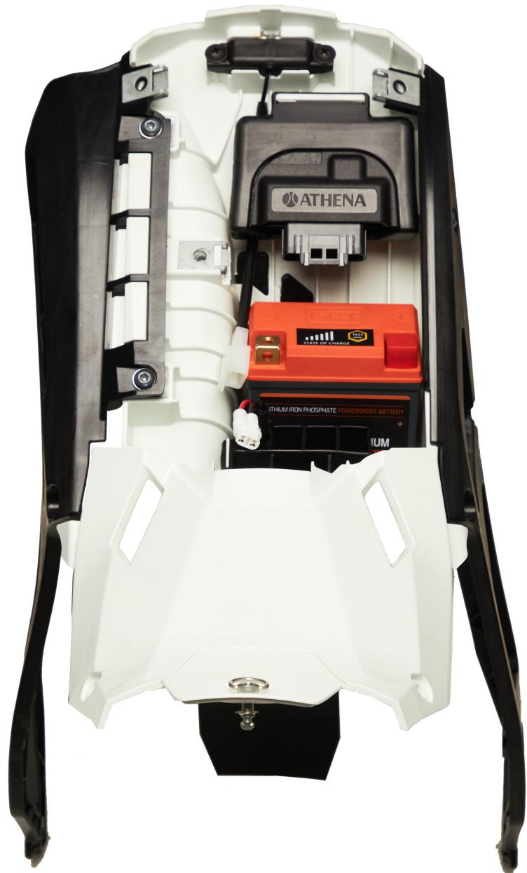
Para este nuevo modelo, el departamento de I+D de Vértigo, en estrecha colaboración con GET, ha desarrollado un nuevo sistema de inyección electrónica asistido por batería, **que mejora y facilita notablemente** el arranque de la moto a la vez que optimiza el funcionamiento de sus componentes eléctricos.
