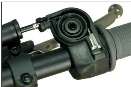
Cable de gas
