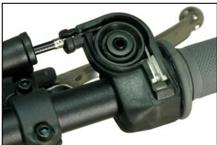
Cable de gas
