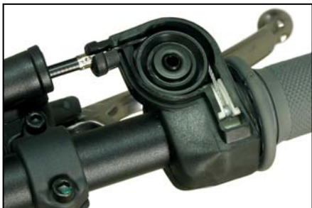
Cable de gas
