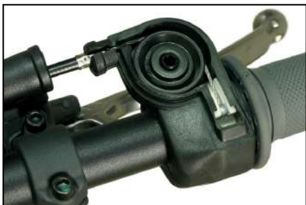
Cable de gas
